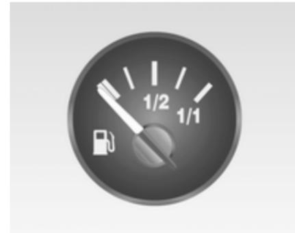
Visualizza il livello del carburante nel serbatoio.
