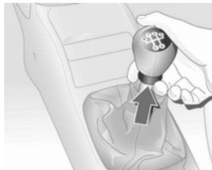
Per inserire la retromarcia, con il veicolo fermo, premere il pedale della frizione, attendere 3 secondi, quindi premere il pulsante sulla leva del cambio e inserire la marcia.
