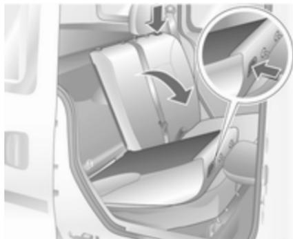
Premere completamente in basso il poggiatesta posteriore esterno o rimuoverlo. Spingere completamente in basso il poggiatesta posteriore centrale ⇄ 36.
