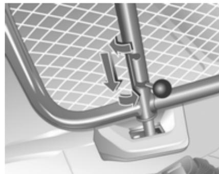
Bloccare la griglia del vano di carico nel fermo. Per farlo, innestare la leva nella posizione bassa.
