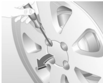
Ruote in lega con bloccaggio antifurto: svitare il cappello del bullone con la chiave antifurto e rimuovere. Attrezzi per il veicolo ⇨ 125.
