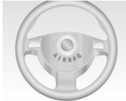
Il sistema airbag anteriore è composto da un airbag nel volante e un airbag nel quadro strumenti sul lato passeggero. La loro presenza viene segnalata dalla scritta **AIRBAG**.
