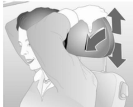
Per regolare, tenere il poggiatesta di lato, inclinarlo in avanti, mantenerlo in posizione e regolare il peso.
