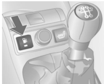
Premendo il pulsante
