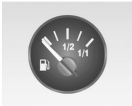
Il display indica la pressione del serbatoio o il livello di benzina, a seconda della modalità di funzionamento.
