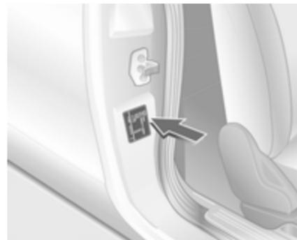
La targhetta di identificazione si trova nel telaio della portiera anteriore destra.
