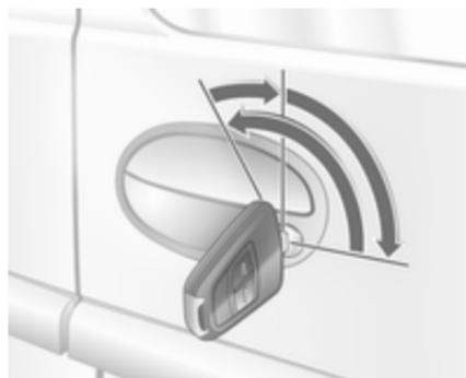
Ruotare la chiave in senso antiorario il più possibile oltre il punto di resistenza dalla posizione verticale od orizzontale e tirare la maniglia della portiera a battente. Per evitare il pericolo di rimanere chiusi fuori, la chiave non può essere rimossa quando si trova in questa posizione. Ribloccare le portiere a battente chiudendole e ruotando la chiave nella posizione orizzontale o verticale.
