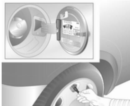
Pressione dei pneumatici ↻ 160 ed etichetta all'interno dello sportellino di rifornimento del carburante.
