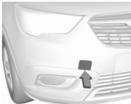
Avvolgere la punta di un cacciavite a taglio con un panno per evitare danni alla vernice. Inserire un cacciavite nella fessura sulla parte inferiore del cappello. Sganciare il coperchio muovendo con cautela il cacciavite verso il basso.
