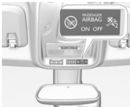
Se la spia
