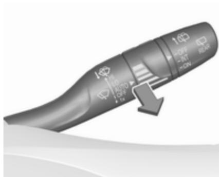
Tirare la leva. Il liquido di lavaggio viene spruzzato sul parabrezza e il tergicristalli effettua alcuni passaggi. Liquido lavacristalli ↪ 189.
