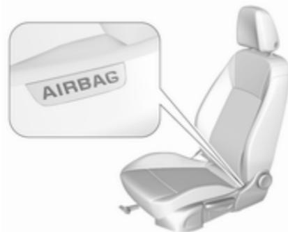
Il sistema airbag laterale è formato da due airbag, uno su ciascun bracciolo del sedile anteriore. La loro presenza viene segnalata dalla scritta **AIRBAG**.
