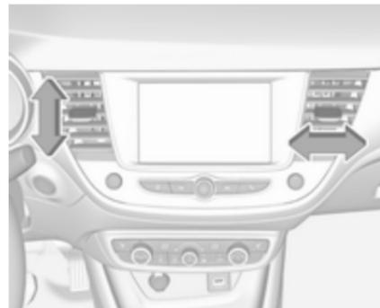
Regolare la direzione del flusso d'aria modificando l'inclinazione orizzontale e verticale delle alette della bocchetta.
