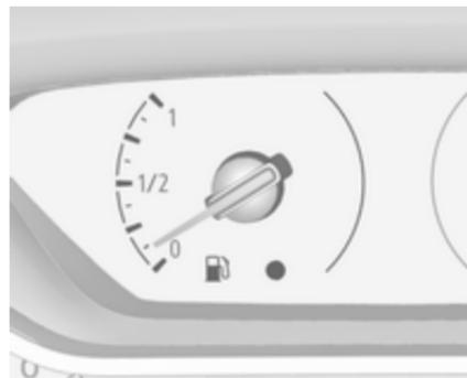
Visualizza il livello del carburante nel serbatoio.
