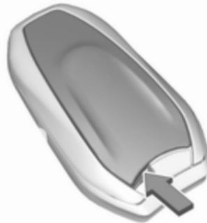
1. Inserire la punta di un piccolo cacciavite nella cavità per sgan-ciare il coperchio.
