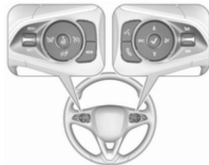
Controllo automatico della velocità di crociera e limitatore di velocità vengono azionati mediante i comandi a sinistra del volante.
