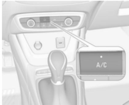
Premere **A/C** per inserire il raffreddamento. L'attivazione è indicata dal LED sul pulsante. Il raffreddamento funziona solamente con il motore acceso e la ventola del climatizzatore inserita.
