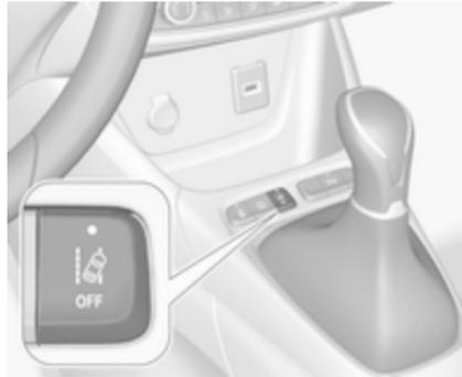
Attivare l'avvisatore di cambio accidentale della corsia di marcia premendo . Il sistema è attivo quando il LED del pulsante è spento. Il sistema funziona solo a una velocità di marcia superiore a 60 km/h e in presenza di segnalazioni orizzontali di corsia.
