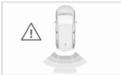
Inoltre, il Visualizzatore Info ⇨ 95 visualizza la distanza dagli ostacoli posteriori modificando le linee di distanza. Quando l'ostacolo è molto ravvicinato, il simbolo di pericolo ⚠ viene visualizzato sullo schermo.
