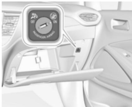
Gli airbag del passeggero anteriore possono essere disattivati tramite un interruttore a chiave nel lato del passeggero del quadro strumenti.
