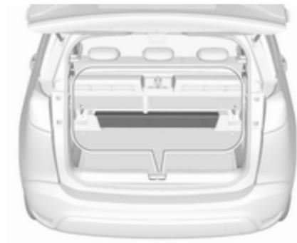
Riporre il triangolo d'emergenza nell'apposito spazio sul retro del vano di carico e fissarlo con il nastro in Velcro®.
