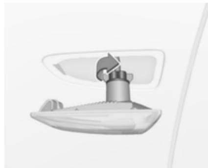
2. Ruotare il portalam-pada in senso antiorario e rimuoverla dall'alloggiamento.
