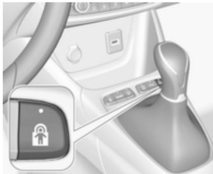
Sistema ad azionamento remoto per impedire l'apertura delle portiere posteriori tramite le maniglie interne.
