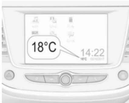
L'illustrazione mostra un esempio. Se la temperatura esterna scende fino a 3 °C, il Driver Information Centre visualizza un messaggio di avvertimento.
