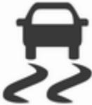
Il sistema ESC e il sistema di controllo della trazione sono operativi dopo ogni avvio del motore appena la spia
