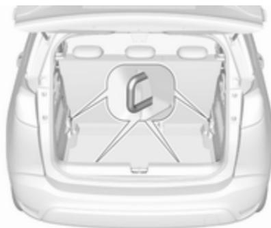
Gli occhielli di ancoraggio servono per fissare gli oggetti ed evitare che scivolino, utilizzando ad esempio delle cinghie di ancoraggio o una rete fermabagagli.
