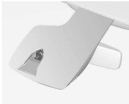
Non applicare adesivi, come i bollini autostradali, sul parabrezza nella zona dello specchietto interno. Mantenere il sensore libero da polvere, sporco e ghiaccio. Altrimenti la zona di rilevamento del sensore pioggia / sensore luci e l'area di visibilità della telecamera nell'alloggiamento dello specchietto potrebbero essere ristrette.
