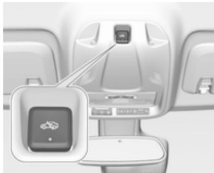
Disinserire il sistema di controllo dell'abitacolo e dell'inclinazione del veicolo quando si lasciano animali nel veicolo. I segnali ultrasonori ad alto volume e i movimenti potrebbero far scattare l'allarme. Disattivare anche se il veicolo viene trasportato su un traghetto o su un treno.
