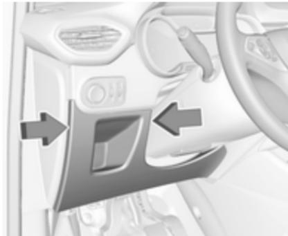
Nei veicoli con guida a sinistra, la scatola portafusibili si trova dietro un pannello del quadro strumenti. Sganciare la copertura sul lato e rimuovere.
