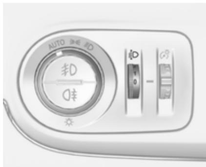
Per regolare la profondità delle luci in base al carico del veicolo e non abbagliare i conducenti dei veicoli in avvicinamento: ruotare la manopola ⇨ nella posizione desiderata.
