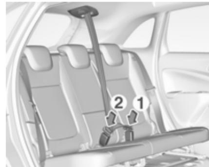
Inserire la piastra di chiusura inferiore nella fibbia sinistra (1) del sedile centrale. Portare la piastra di chiusura superiore, con la cintura, sopra la zona addominale e la spalla (non attorcigliare) e innestarla nella fibbia destra (2) del sedile centrale.
