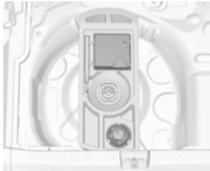
Il kit di riparazione dei pneumatici si trova nel vano di carico sotto la copertura del pianale.
