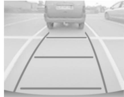
L'area dietro al veicolo viene mostrata sullo schermo. Le linee verticali corrispondono alla larghezza del veicolo con gli specchietti aperti. La direzione delle linee cambia a seconda dell'angolo di sterzata.
