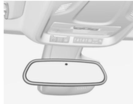
L'abbagliamento proveniente dai veicoli che seguono viene automaticamente ridotto, quando si guida al buio.
