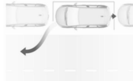
Avanzare o indietreggiare seguendo gli avvertimenti del sistema di ausilio al parcheggio fino a quando non viene segnalata la fine della manovra. La manovra è completa quando le ruote posteriori del veicolo sono fuori dal parcheggio e  $P_{\text{a}}$  si spegne nel quadro strumenti.
