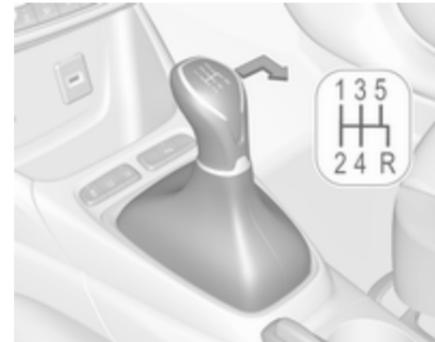
Per inserire la retromarcia con un cambio a 5 marce, premere il pedale della frizione e portare la leva del cambio a destra e indietro.
