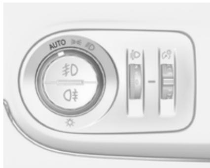
Quando la funzione di comando automatico dei fari è attivata e il motore è in funzione, il sistema passa dalle luci diurne all'accensione dei fari automaticamente, a seconda delle condizioni della luminosità esterna e delle informazioni fornite dal sistema dei tergicristalli.
