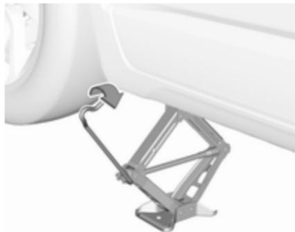
Fissare la chiave delle ruote e, con il martinetto correttamente allineato, ruotare la chiave fino a sollevare la ruota dal terreno.
