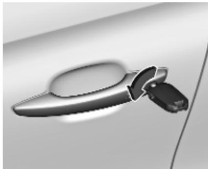
Girare la chiave nel cilindro della serratura della portiera del conducente.
