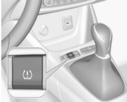
In seguito ad una correzione della pressione pneumatici o al cambio di una ruota, è necessario avviare il sistema per permettere la memorizzazione dei nuovi valori di circonferenza di riferimento:
