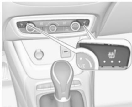
Regolare il riscaldamento sul livello desiderato premendo
