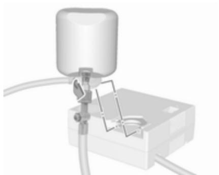
4. Avvitare il flessibile dell'aria del compressore sul raccordo della bombola del sigillante.
