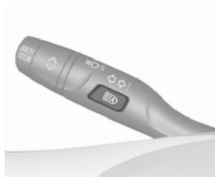
Azionare l'assistente all'uso degli abbaglianti premendo  $\text{90}$ . Il LED del tasto si accende.
