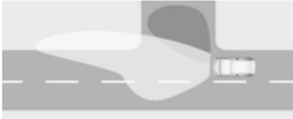
In curva, in base all'angolo di sterzata e alla luce degli indicatori di direzione, vengono azionati dei particolari LED che illuminano la direzione di marcia. Si attiva fino ad una velocità massima di 40 km/ora.
