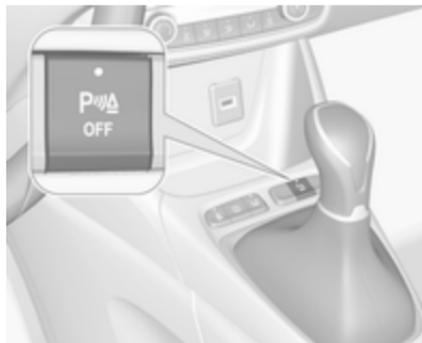
Il sistema si disattiva disinserendo la retromarcia. Premere **P OFF** per disattivare manualmente il sistema. Il LED del pulsante si accende quando il sistema viene disattivato. Se il sistema viene disattivato manualmente, non si riattiverà automaticamente la prossima volta che si inserisce l'accensione.
